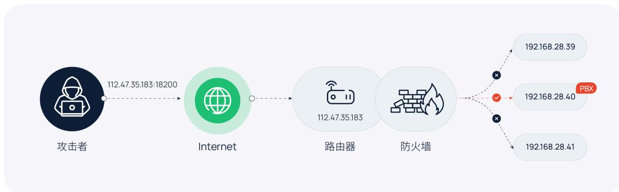
Yeastar P 系列软件版 提供隧道服务，可在不映射端口的情况下帮助企业实现电话系统的远程访问。使用隧道服务，你可以自定义 PBX 域名，还可以通过 Linkus UC 客户端实现远程协同办公和电话系统管理。此外，隧道服务支持通过访问权限控制来进一步增强安全性。你可以设置是否允许通过隧道服务进行远程 SIP 注册，或者远程访问网页、Linkus、LDAP 或 API，并通过分机、部门、IP 地址等限制规则实现更精细的访问控制。
