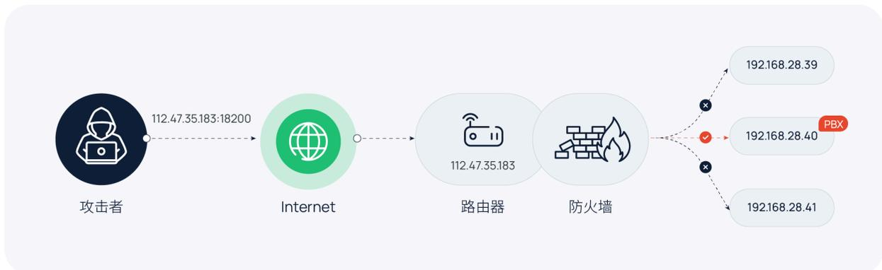
Yeastar P 系列 IPPBX 提供隧道服务，可在不映射端口的情况下帮助企业实现电话系统的远程访问。使用隧道服务，你可以自定义 PBX 域名，还可以通过 Linkus UC 客户端实现远程协同办公和电话系统管理。此外，隧道服务支持通过访问权限控制来进一步增强安全性。你可以设置是否允许通过隧道服务进行远程 SIP 注册，或者远程访问网页、Linkus、LDAP 或 API，并通过分机、部门、IP 地址等限制规则实现更精细的访问控制。
